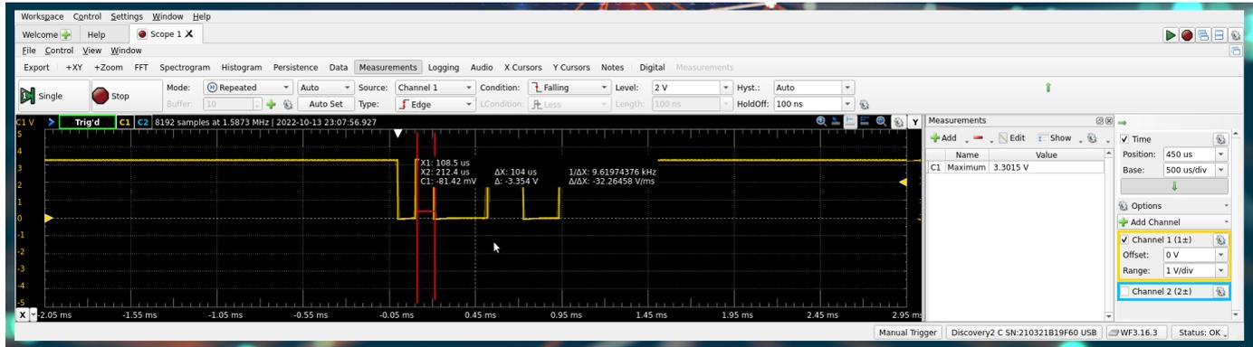
Ici, on voit que  $1/\Delta X = 9,6\text{KHz}$  ce qui est le cas : on a configuré le port série pour une transmission à 9600bps :
