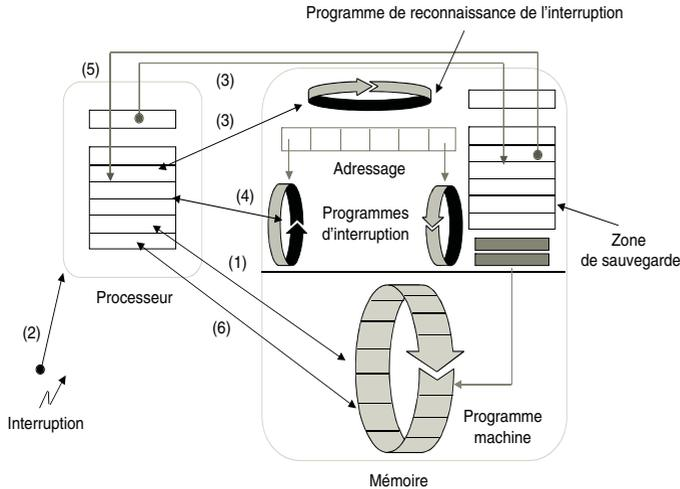
1. le programme utilisateur dispose du processeur. C'est lui qui est en cours d'exécution. Il dispose des registres, de l'unité arithmétique et logique, de l'unité de commande. Le compteur ordinal CO contient l'adresse de la prochaine instruction à exécuter ;
