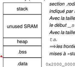
le transfert de la section `.data` de la flash vers la sram est fait dans le «startup.s»
