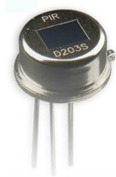
**Capteur PIR** : capteur électronique qui mesure la **quantité de lumière infrarouge** diffusée par les objets dans son champs de vision.
