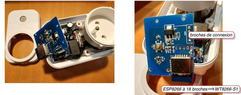
Identifier les broches du WT8266-S1 à l'aide d'un multimètre et de la doc constructeur
