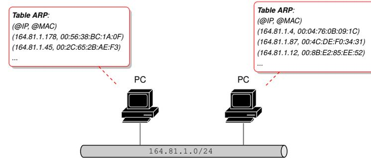
La modification malveillante de cette table est possible : «ARP Spoofing» (usurpation d'identité), «ARP Cache Poisoning» (insertion d'association erronée).
