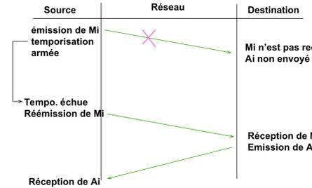
Dans la suite des transparents, le temps d'attente avant réémission automatique est appelé *RTO*, «Retransmission TimeOut», et il est calculé en fonction du *RTT* d'un segment (temps de transmission du segment+temps de réception de l'acquittement).
