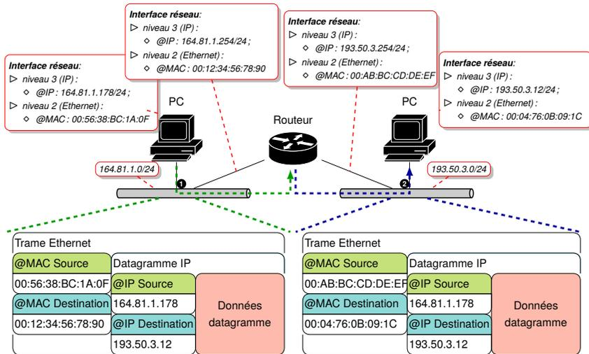
L'encapsulation permet la redirection vers le routeur sans modifier les @IP du datagramme.
